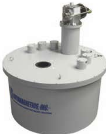
带 76mm 室温孔的三轴 (5T-1T-1T) 系统
