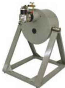
5T 中心磁场 61mm 室温孔，有垂直或水平通道
