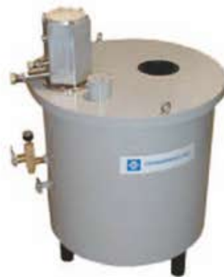
52mm 室温孔的 9T 超导磁体
