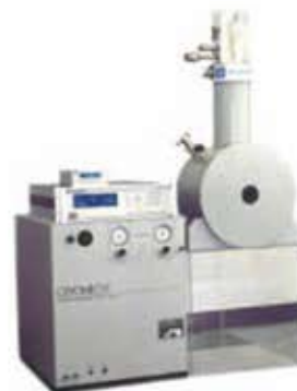
52mm 室温孔的分立线圈对超导磁体 (6T@ 助磁, 3T 峰-峰 @ 阻磁)
