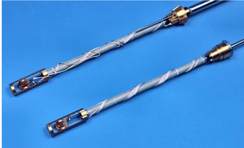
He-4 和 He-3 恒温器中带精确旋转器的样品探针
