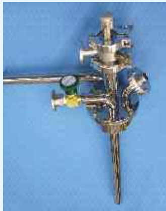
STVP-300-NMR专为NMR实验设计，高温达475K，由于励磁绕组间空间限制，恒温器的bayonet arm和vent ports设计成相互平行，用户在恒温器内使用特制的NMR探针。
