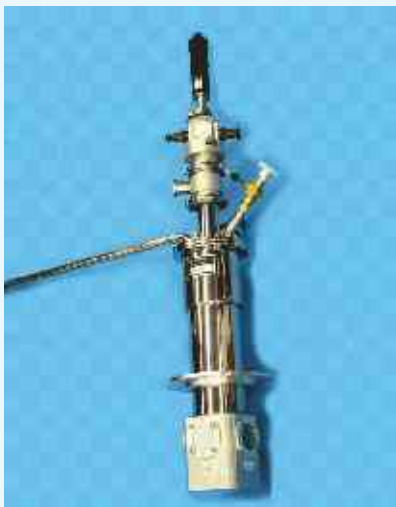
与Bomem FTIR光谱仪匹配的STVP恒温器
